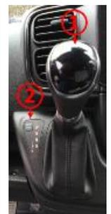
Für Fahrten in bergigem Gelände und auf Strecken mit vielen Geschwindigkeitswechseln empfehlen wir die Verwendung der TOW/HAUL-Funktion. Sie verhindert, dass das Getriebe in den höchsten Gang schaltet, verleiht dem Fahrzeug beim Bergauffahren zusätzliche Leistung und erhöht die Bremskraft beim Bergabfahren, um das Risiko einer Überhitzung der Bremsen zu verringern. Wählen Sie die Funktion durch Drücken der Taste TOW/HAUL ②.
