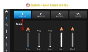
PUMP ③ schalten Sie die Pumpe ein. Bitte schalten Sie die Pumpe während der Fahrt, bei längerem Nichtgebrauch und bei Anschluss an das städtische Wasser ab, da sie überhitzen kann. Für daraus resultierende Schäden ist der Mieter verantwortlich.
